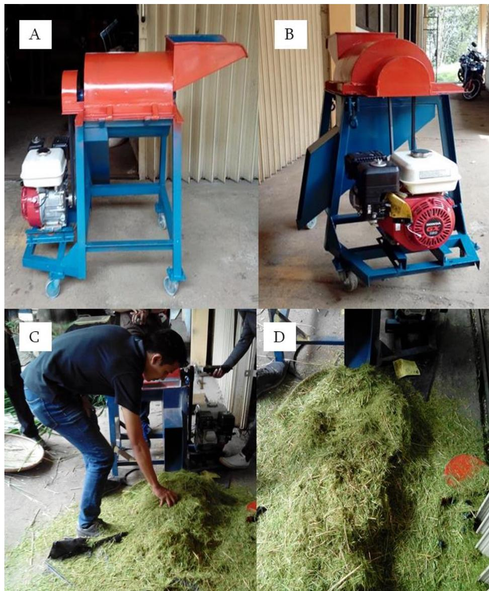
Gambar 8. Prototipe mesin pencacah jerami padi. Mesin pencacah tampak samping (A), mesin pencacah tampak depan (B) dan shsil cecahan jerami (C, D).
