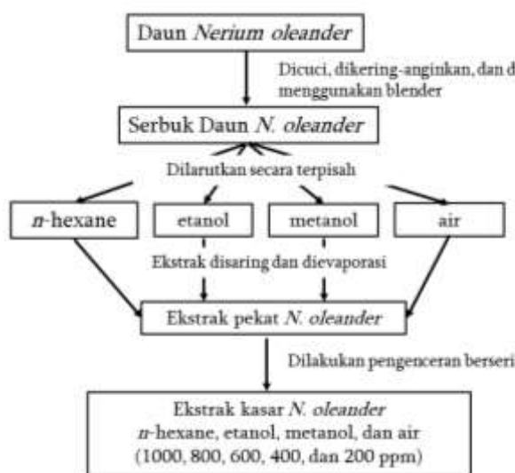
Gambar 2. Diagram proses ekstraksi pelarut N. oleander
