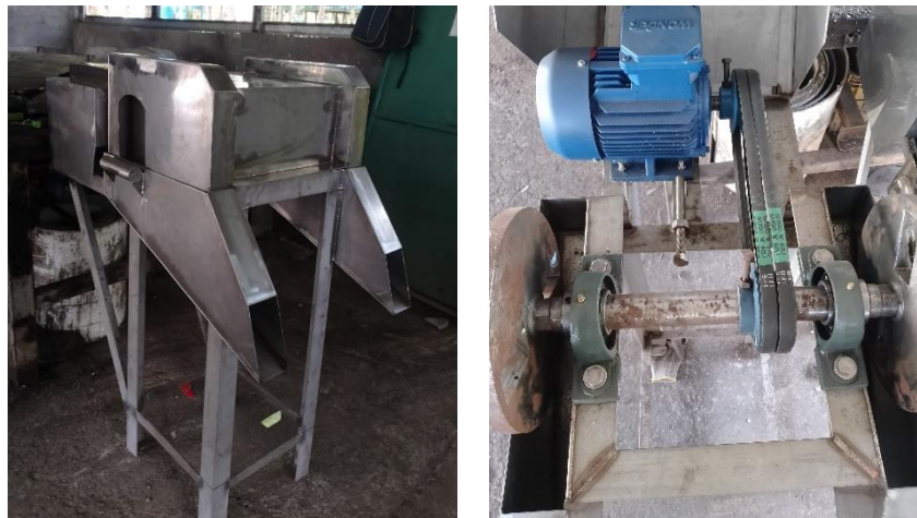
Gambar 3. Hasil rancang bangun mesin pengupas kulit ari kelapa.
