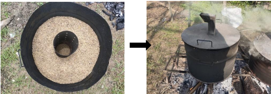
Gambar 1. Pembuatan biochar sekam padi dengan metode pirolisis. Sekam padi dimasukkan ke dalam alat (kiri) kemudian ditutup dan dipanaskan (kanan).
