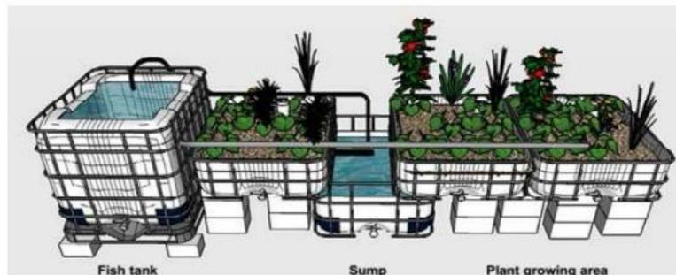
**Gambar 5** Ilustrasi Sistem Akuaponik Desain Konstruksi Media Bed
