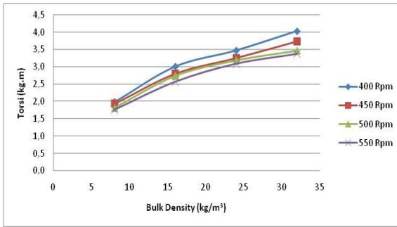
Gambar 5. Grafik hubungan torsi pemotongan dengan tingkat kepadatan.
