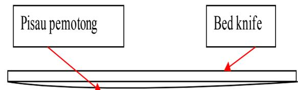
Gambar 14. Kondisi pemotongan dengan menggunakan pisau lurus.
