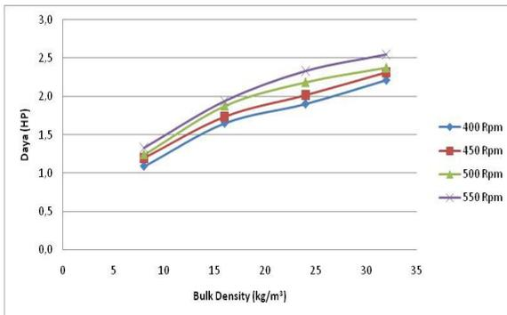
Gambar 6. Kebutuhan daya untuk mesin pencacah serasah tebu.
