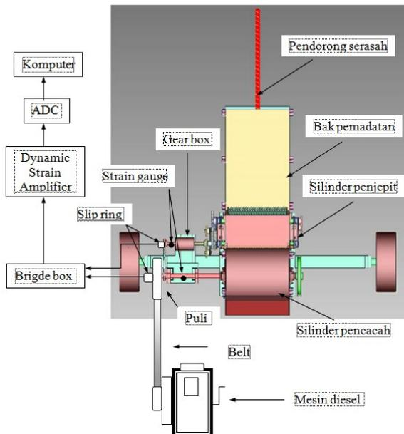
Gambar 3. Skema pengukuran torsi pemotongan serasah tebu.
