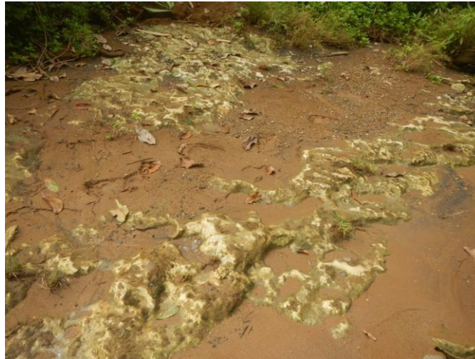
Gambar 5. Sedimentasi pada singkapan Kalkarenit pada tebing kanan rencana Bendungan Parigi
