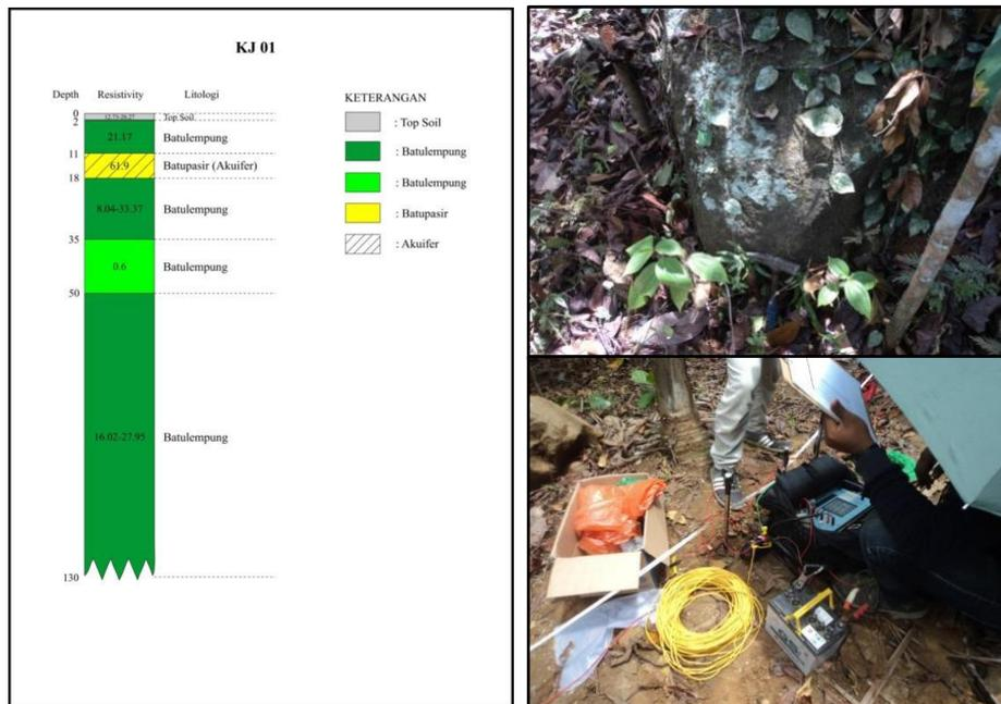
**Gambar 8.** Hasil Analisis Geolistrik di Lokasi KJ-01, terlihat adanya lapisan batupasir yang bisa menjadi lapisan pembawa air (akuifer) pada kedalaman 11-18 meter dengan tebal sekitar 7 meter, gambar sebelah kanan foto-foto di lokasi sounding geolistrik KJ-01
