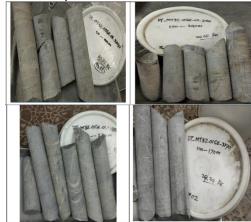
Gambar 7. Sampel bor inti untuk drop test dan abrasion test.
