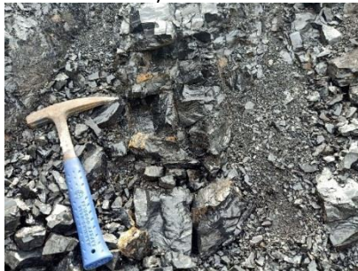
Gambar 5. Foto dekat lapisan 5 Batubara Seam H dengan strike/dip N 334°E/ 25°
