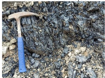
Gambar 9. Foto dekat lapisan 9 Batubara Seam J dengan strike/dip N 320°E/ 19°
