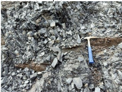
Gambar 11. Foto dekat lapisan 11 Batubara Seam K dengan strike/dip N 322°E/ 19°
