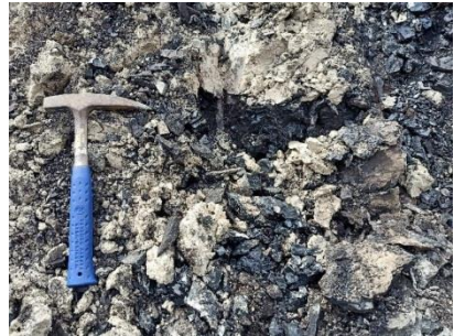
Gambar 7. Foto dekat lapisan 7 Batubara Seam I dengan strike/dip N 328°E/ 18°
