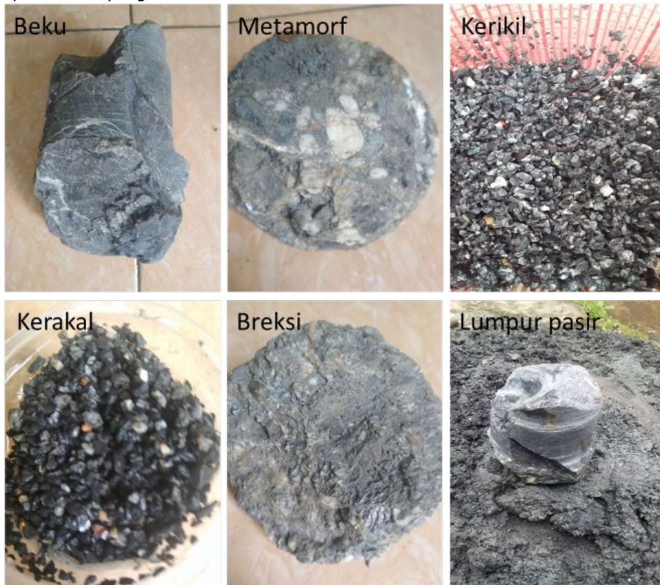
Gambar 11. Jenis batuan bawah permukaan yang berhasil diangkat ke permukaan saat pengeboran sumur di kompleks Masjid At-Taqwa Desa Petir, Kecamatan Purwanegara, Kabupaten Banjarnegara.
