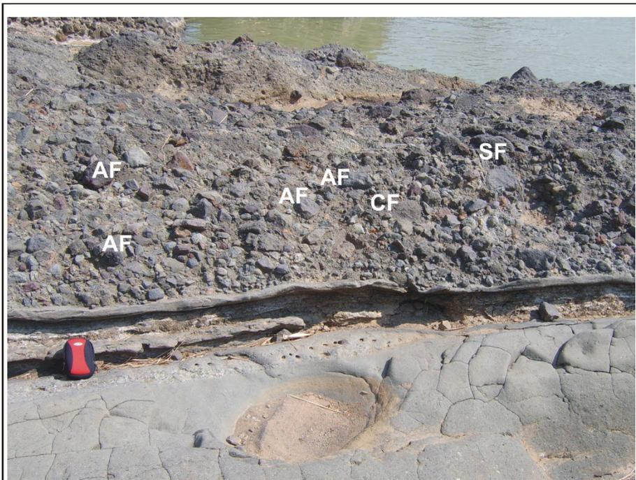
Gambar 2 Contoh singkapan (Stasiun pengamatan 37) Facies Batupasir konglomeratik (Facies A), AF=Andesit fragment; CF=Clay fragment; SF=Sandstone fragment dengan bidang kontak tegas Facies A dengan litofacies dibawahnya
