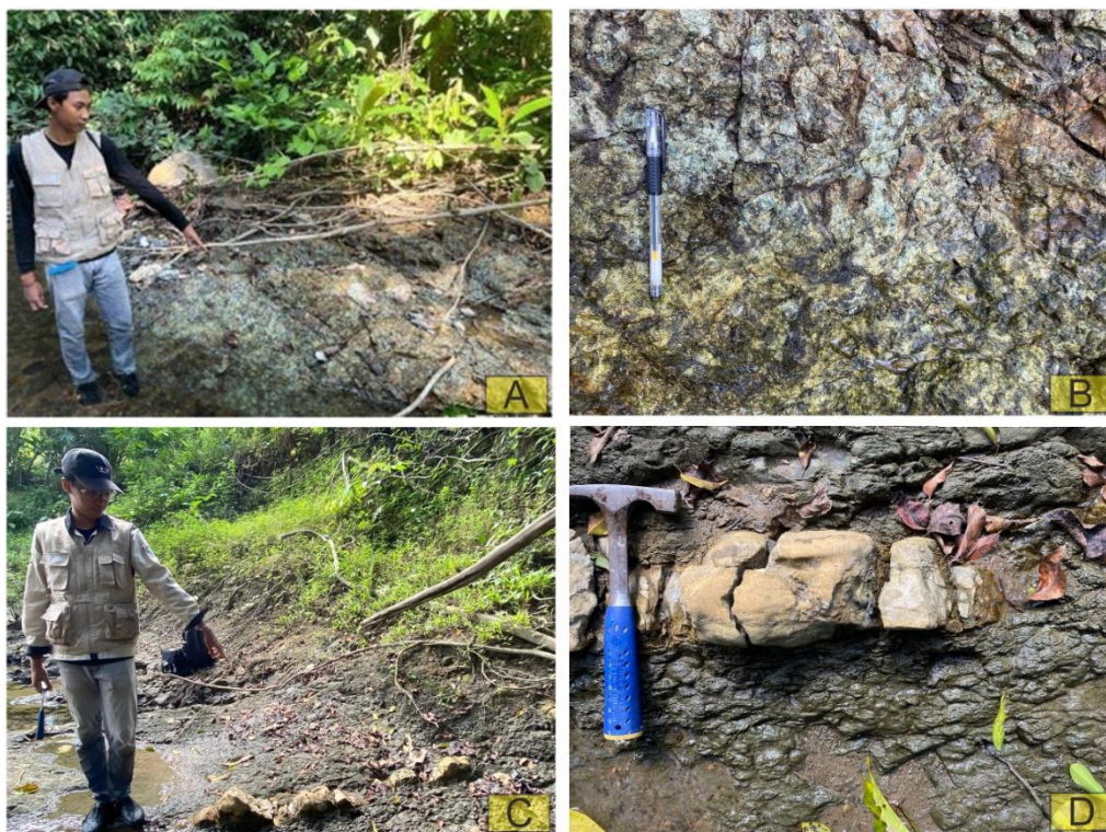
Gambar 4. a. Foto Singkapan Jarak Jauh Batupasir dengan Struktur Bedding , b. Foto Singkapan Jarak Dekat Batupasir Karbonatan, c. Foto Singkapan Jarak Jauh Batuserpih Sisipan Batugamping, d. Foto Singkapan Jarak Dekat Batuserpih dengan Struktur Laminasi serta Sisipan Batugamping yang membentuk struktur bedding .
