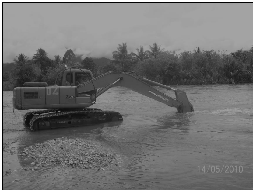
Gambar 3. Pengerukan bebatuan di Sungai Meko tampak dalam 4 meter
