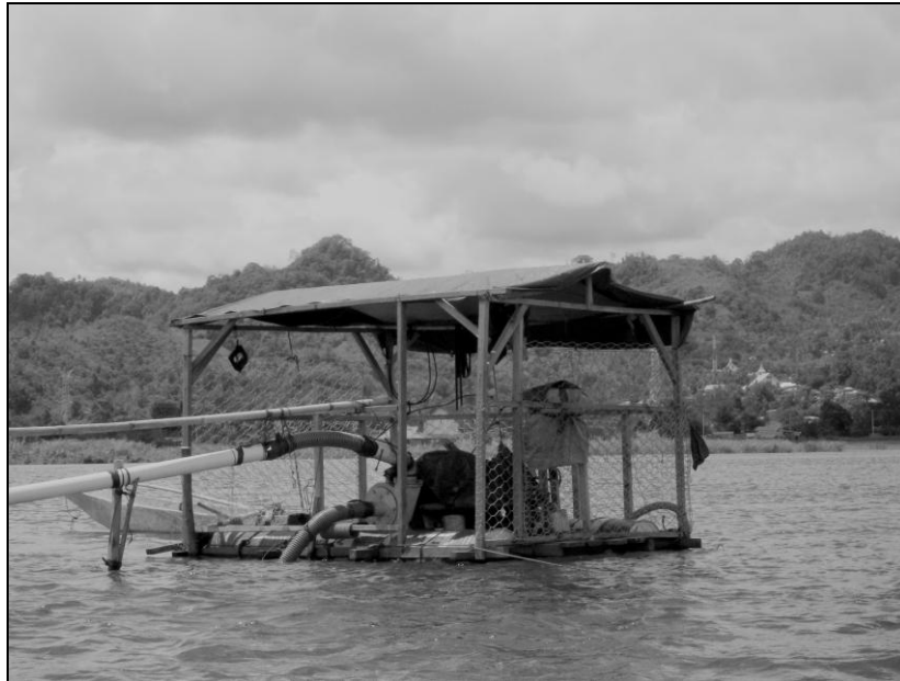
Gambar 2. Mesin Penyedot Pasir di Tentena
