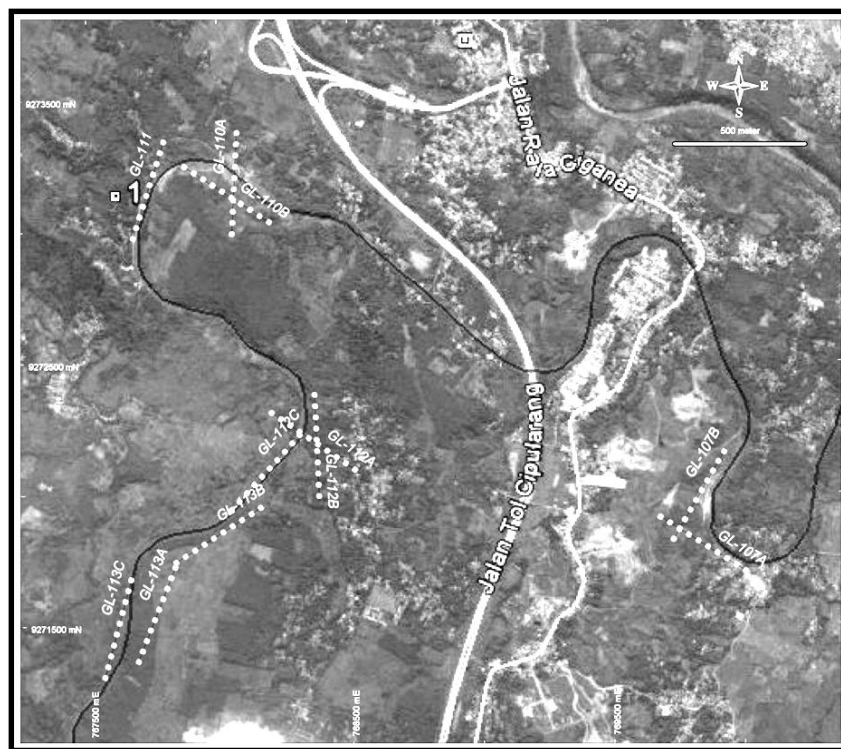
Gambar 7. Peta lintasan pengukuran geolistrik.
