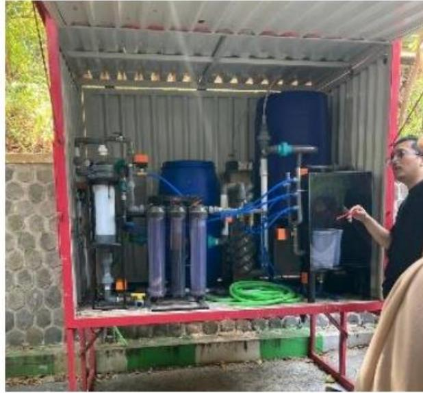
**Gambar 2.** Solisalisasi dan Pengenalan alat sistem RAS untuk penyaringan air.
