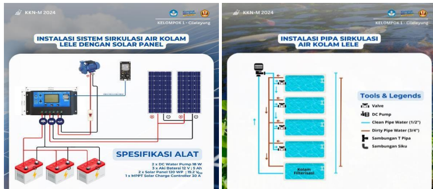
Gambar 2. Panel surya untuk sistem sirkulasi air kolam
