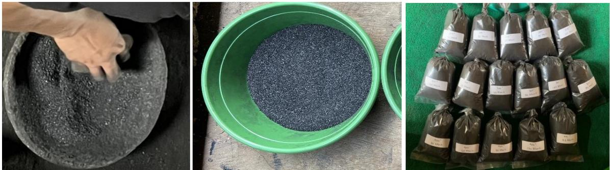
**Gambar 3.** Foto proses penghalusan dan kemasan arang
