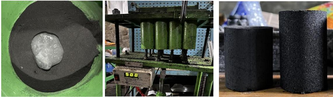
**Gambar 4.** Foto proses pembuatan biobriket dari mulai pencampuran perekat, pencetakan dan pengeringan
