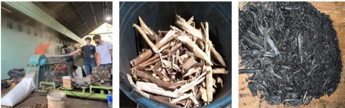
**Gambar 2.** Foto proses pencacahan dan pembuatan arang
