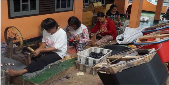
Gambar 1. Proses penggulangan benang secara manual
