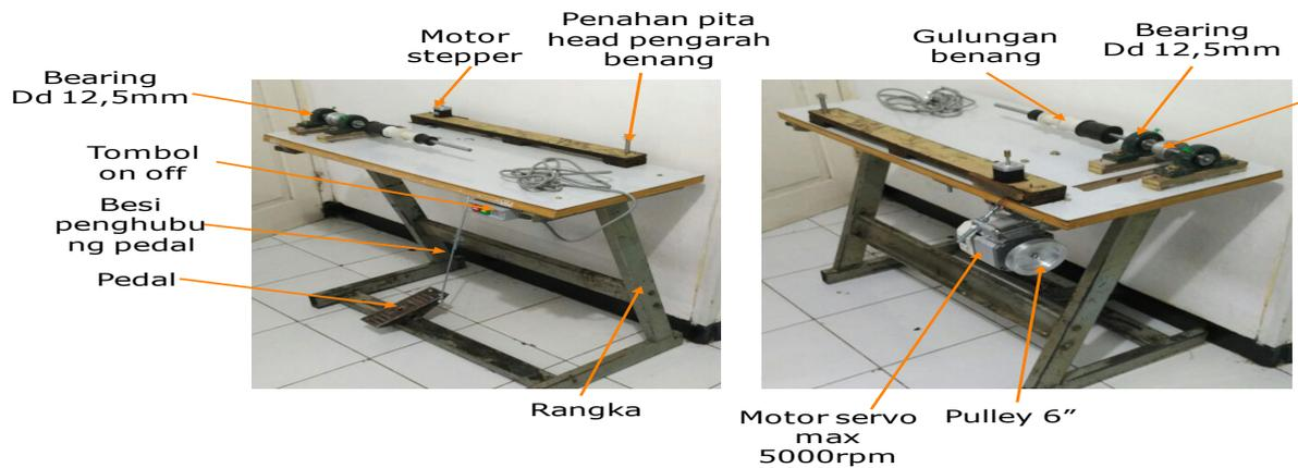
Gambar 6. Hasil rancangan mesin penggulung benang gelasan otomatis
