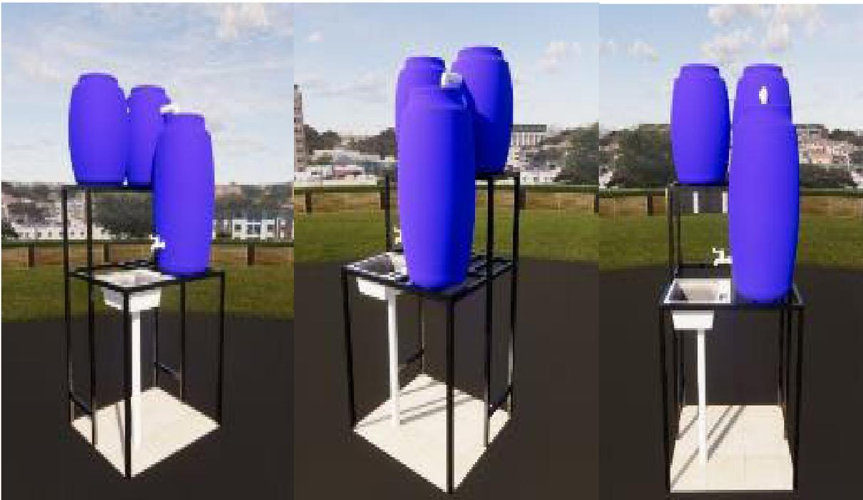
Gambar 3. Alat pemanenan air hujan untuk kebutuhan air bersih cuci tangan
