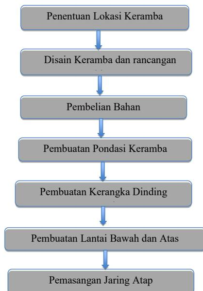
**Gambar 2. Langkah Pembuatan Keramba**
