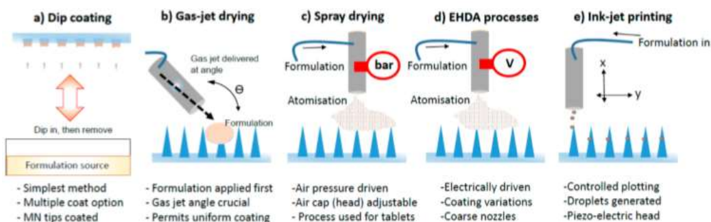
Gambar 2. Contoh ilustrasi teknik yang digunakan untuk MN coat. (a) Dip coating ; (b) Gas-jet drying ; (c) Spray drying ; (d) proses EHDH; (e) Ink-jet printing (Haj-Ahmad, et al., 2015).
