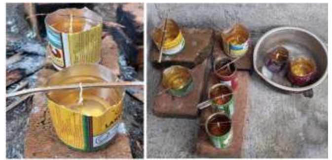
Gambar 3. Proses pembuatan lilin dari minyak jelantah. Pada tahap ini, bahan lilin yang sudah homogen kemudian dimasukkan secara perlahan ke dalam cetakan lilin.
