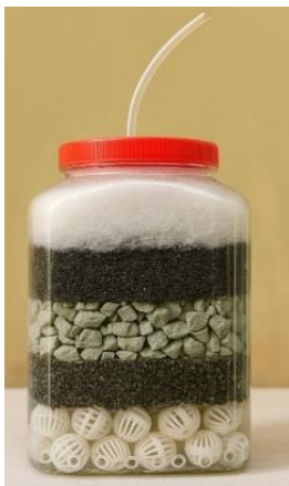
Gambar 4. Desain filter tenggelam
