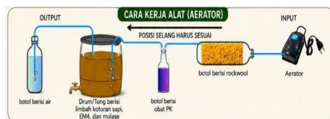
Ilustrasi 3. Sistem Kerja Pembuatan Pupuk Organik Cair
