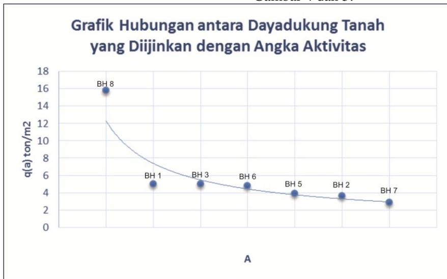
**Gambar 4.** Gravik Hubungan antara dayadukung tanah yang diijinkan dengan aktivitas lempung
