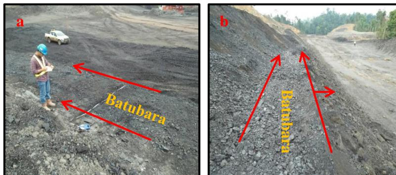
**Gambar 4.1** Foto *seam* batubara pada daerah penelitian: (a) Arah jurus batubara pada daerah penelitian mengarah utara-selatan, azimut foto 220°; (b) Kemiringan batubara pada daerah penelitian yang mengarah ke barat, azimut foto 194°.
