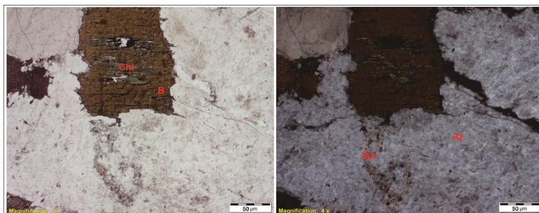
Gambar 4. Foto mikroskopis sienit pada stasiun HN2. Foto PPL (kiri) XPL (kanan) (perbesaran 40x).
