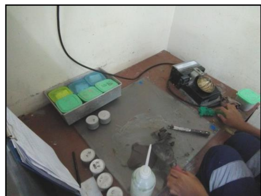
Gambar 5. Pengujian Atterberg Limit di Laboratorium Mekanika Tanah PT. Bukit Asam, Tbk.
