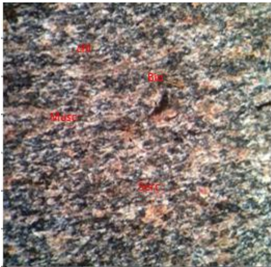
Gambar 2. Struktur schistose dengan komposisi muskovit (Musc), klorit (chl), serisit (Serc), dan biotit (bio).
