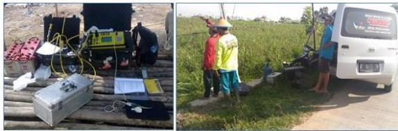
Gambar 5. Alat geolistrik SuperSting R8/IP (persiapan di lintasan 3)
