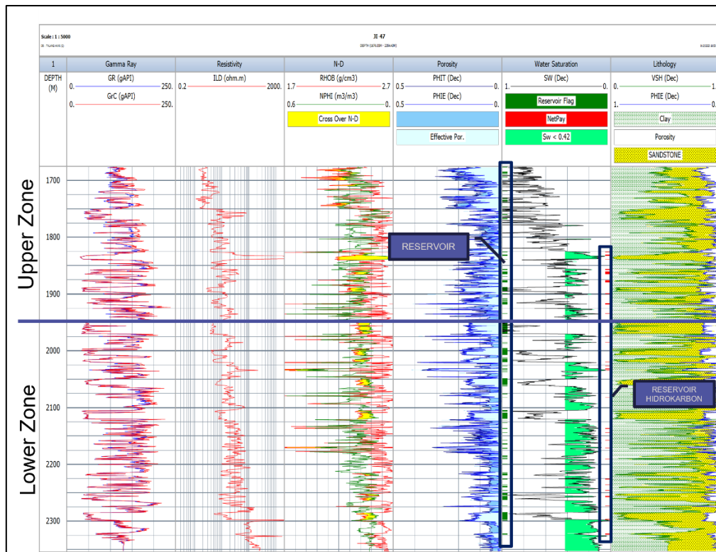
Gambar 6. Zona reservoir dan zona reservoir hidrokarbon setelah dilakukannya cut-off pada sumur JI-47
