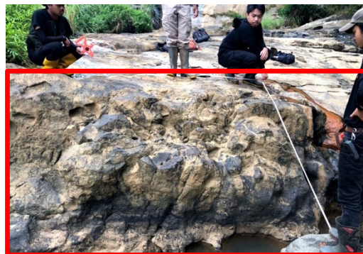
Gambar 16. Pengukuran Data Kekar Pada Litologi Batupasir
