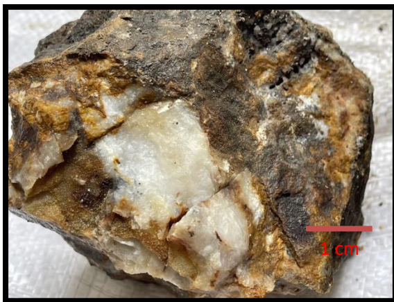
Gambar 3 Sampel TTY23M038R dengan Tekstur Urat Kuarsa Masif
