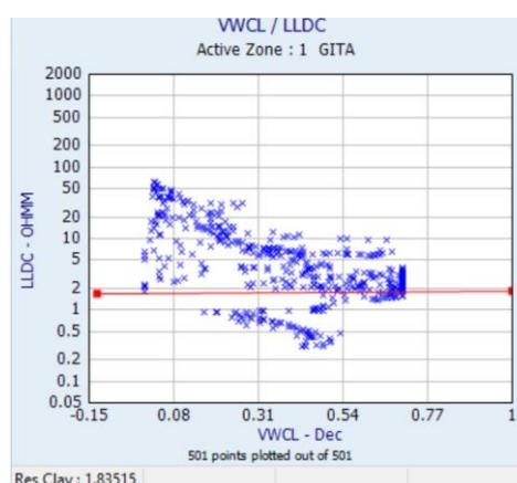
Gambar 4. 6 Crossplot *Vshale* (Vwcl) dan LLD dalam penentuan resistivitas *shale* (Rsh)
