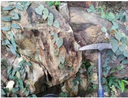
Gambar 6. Kenampakan megaskopis tuf terubahkan menjadi mineral alunit dan mineral lempung
