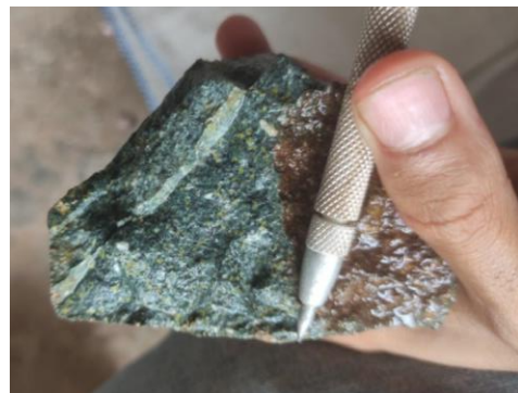
Gambar 8. Kenampakan megaskopis lava andesit teralterasi klorit + epidot
