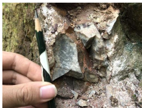
Gambar 5. Kenampakan megaskopis tuf tersilisifikasi
