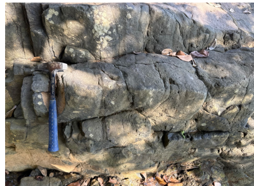
Gambar 11. Foto singkapan basaltik dengan struktur kekar kolom di daerah Sungai Ciseureuh (D7 – ST87)"
