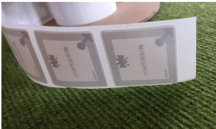
**Gambar 1. Foto RFID berbentuk stiker**
