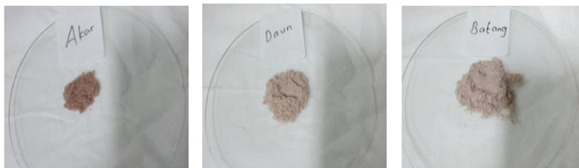
Gambar 4. Perbedaan warna katalis abu ilalang (akar, daun, batang) setelah proses pengabuan
