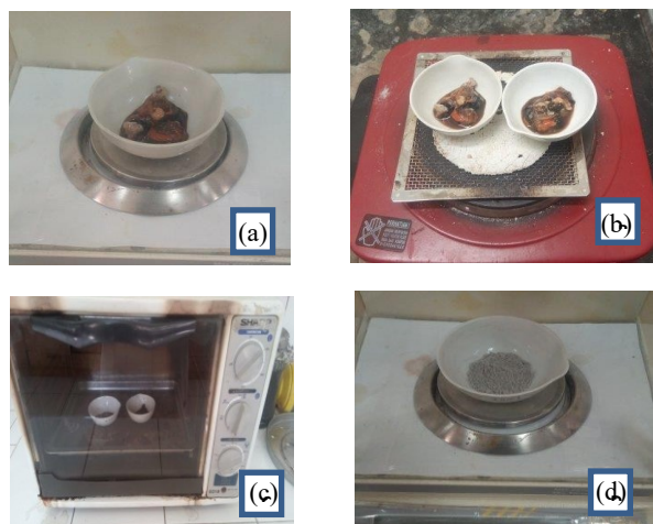
Gambar 3. Tahap proses destruksi kering. (a) penimbangan sampel kerang hijau, (b) sampel dikeringkan menggunakan hot plate, (c) Proses pengeringan kembali dengan menggunakan oven, (d) penimbangan sampel yang telah menjadi abu
