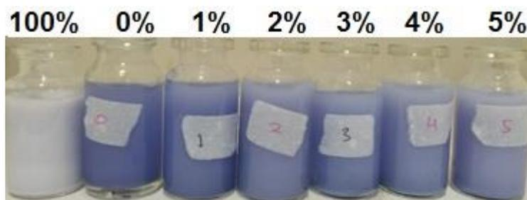
**Gambar 5.** Suspensi bahan glasir dengan penambahan TiO<sub>2</sub> 0, 1, 2, 3, 4, dan 5% serta serbuk TiO<sub>2</sub> 100% setelah disinari UV
