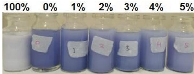
**Gambar 7.** Endapan bahan glasir hasil penyinaran UV untuk penambahan  $\text{TiO}_2$  0-5% dan serbuk  $\text{TiO}_2$  100%
