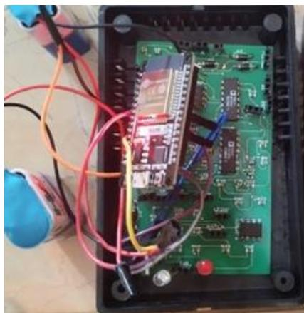
**Gambar 2.** Perangkat Pemantau Gelombang Otak
