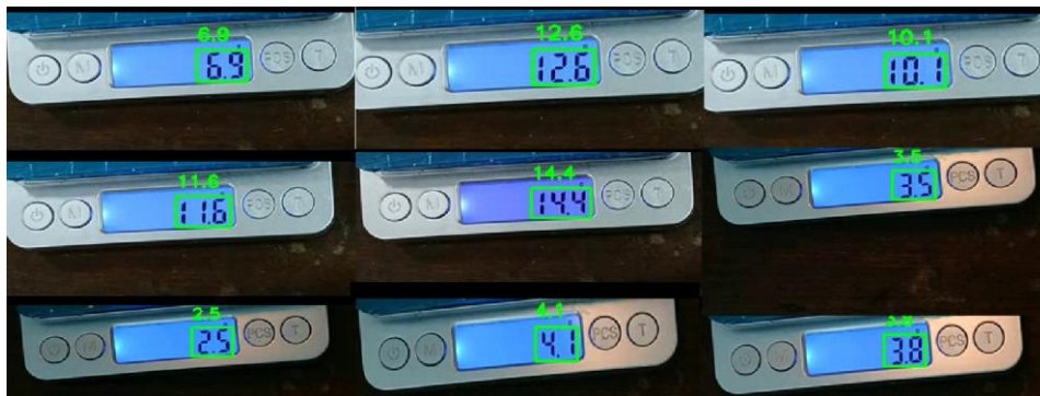
Gambar 5. Pengenalan Bilangan Pecahan Desimal yang dilakukan oleh Sistem Pencatat Data Real-time pada Eksperimen Pembakaran Alkohol 95%, Aseton dan Etanol
