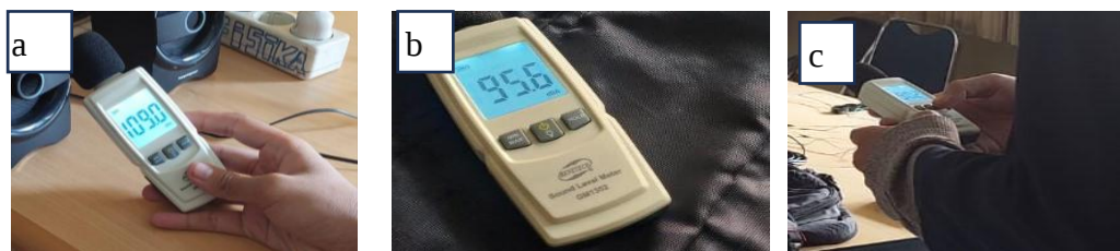
Gambar 8. (a) Pengukuran SPL pada jarak 10 cm; (b) pengukuran SPL pada jarak 2 m; (c) pengukuran SPL pada jarak 3 m
