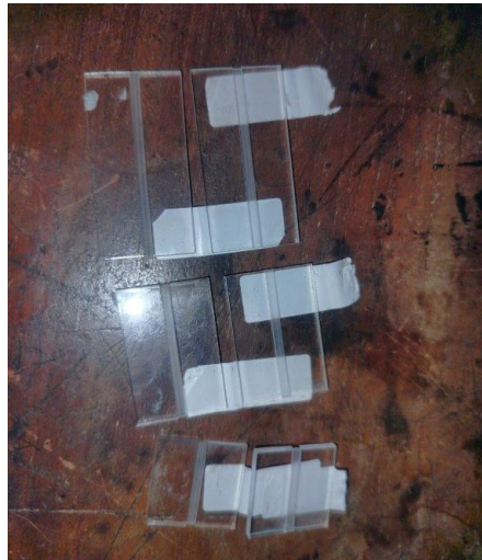
Gambar 7. Cladding Akrilik Variasi Panjang 2, 3, 4 cm
