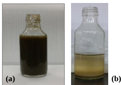
Gambar 4. Perbandingan Penampilan Visual Air Limbah Tekstil: (a) Sebelum Pengolahan, (b) Setelah Pengolahan dengan Elektroflotasi
