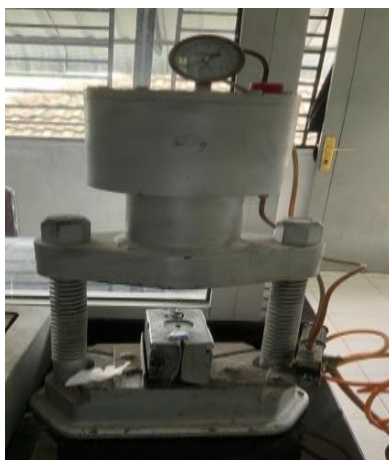
Gambar 3. Nilon termoplastik diinjeksikan ke dalam kuvet. (Sumber: dokumentasi pribadi)
