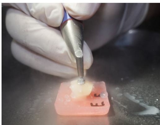
Gambar 3. Prosedur air polishing dilakukan dengan jarak antara ujung handpiece dengan permukaan breket sebesar 3 mm. (Sumber: Dokumentasi pribadi)
