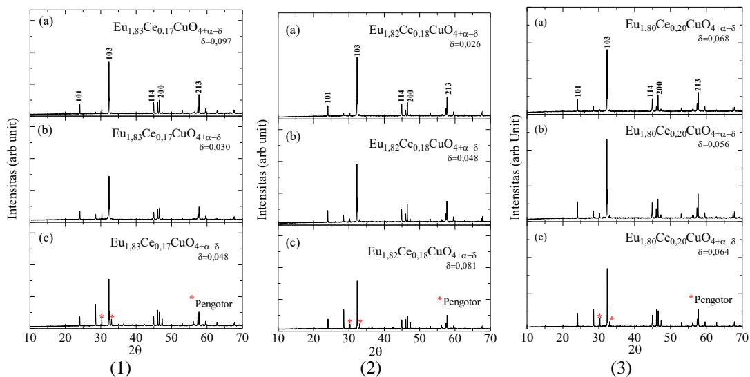
**Gambar 1.** Hasil karakterisasi pada sampel ECCO konsentrasi doping (1)  $x=0.17$  dengan (a)  $\delta=0.097$ , (b)  $\delta=0.029$ , dan (c)  $\delta=0.048$ , (2)  $x=0.18$  dengan (a)  $\delta=0.026$ , (b)  $\delta=0.048$ , dan (c)  $\delta=0.091$ , dan (3)  $x=0.20$  dengan (a)  $\delta=0.056$ , (b)  $\delta=0.068$ , dan (c)  $\delta=0.064$ .
