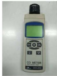
**Gambar 1.** Alat Uji CO meter
